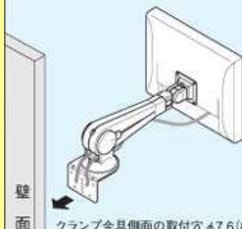
クランプタイプLA-31の壁面取付例
